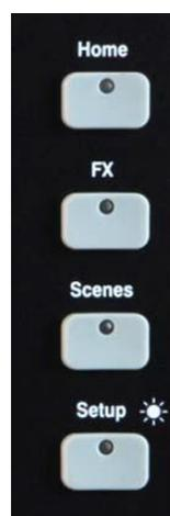
**Home** – Pages de fonctions de maintenance : extinction sécurisée, verrouillage de surface, création et changement de profils utilisateur, affichage des indicateurs de niveau et de l'analyseur en temps réel (RTA), enregistrement et lecture stéréo et multipiste sur Qu-Drive.
