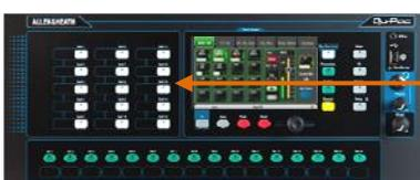
**Touches programmables** – Utilisez-les pour un accès rapide aux fonctions couramment utilisées telles que Mutes, rappel de certaines scènes, navigation dans les scènes, battue manuelle du tempo, contrôle du transport sur Qu-Drive, talkback vers la scène, effacement de PAFL active et autres. Ces touches se programment en écran **Setup / Control / SoftKeys**.
