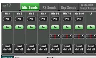
**Écran Routing** – Cet écran vous permet de travailler avec les départs d'un canal vers tous les mixages, ou d'accéder aux réglages globaux et aux options de routage pour les mixages. Pour travailler avec les départs de tous les canaux vers un mixage, utilisez la fonction Mix Select de l'écran **Channel**.
